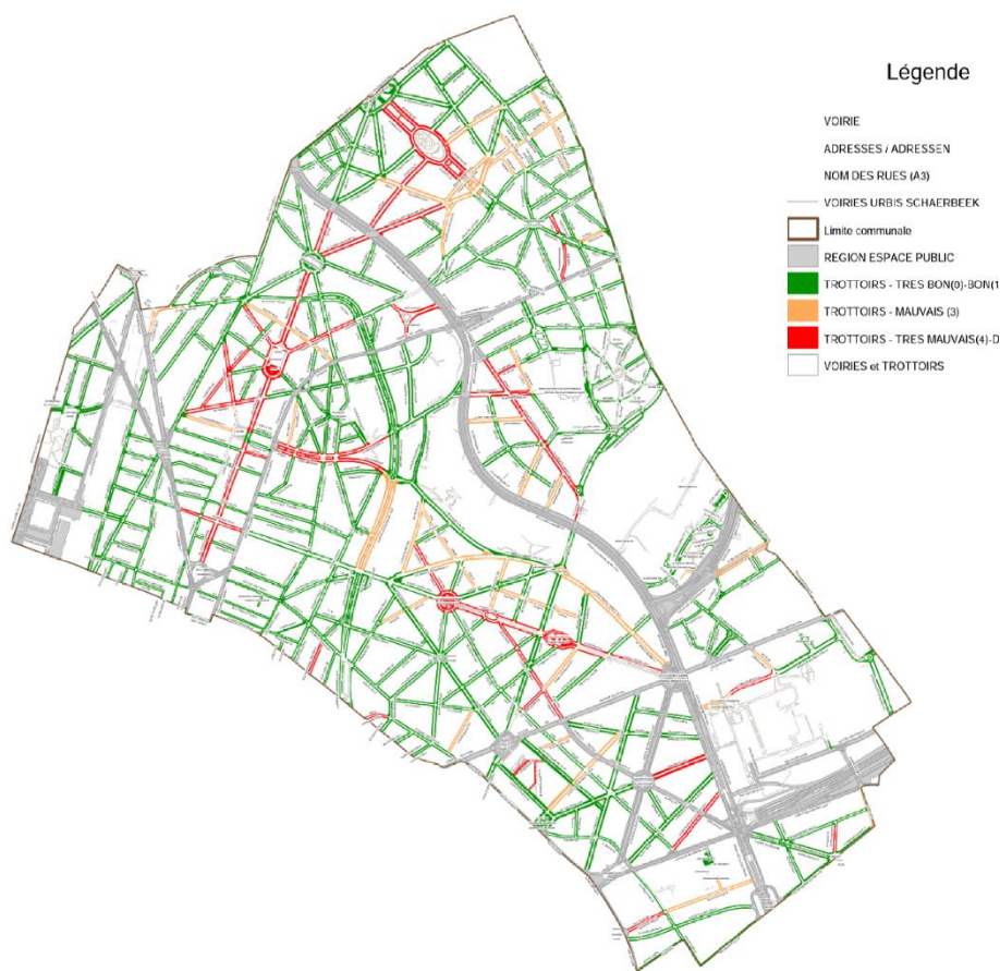
Figure 7 : Relevé de l'état des trottoirs sur la commune de Schaerbeek
