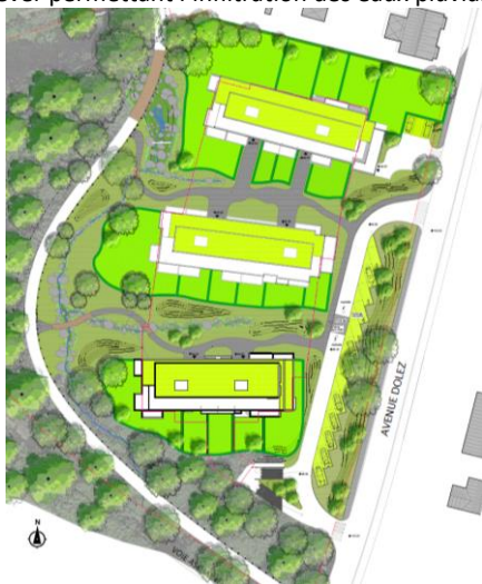
Projet Privé Paturins : gestion des eaux pluviales via des dispositifs paysager à ciel ouvert
